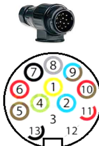
Schemat 2. Schemat instalacji elektrycznej złącze 13- pinowe
