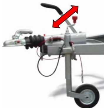
Rys. 6. Ustawienie hamulca postojowego przyczepy
