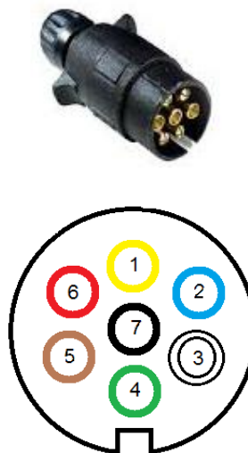
Schemat 1. Schemat instalacji elektrycznej złącze 7- pinowe.
