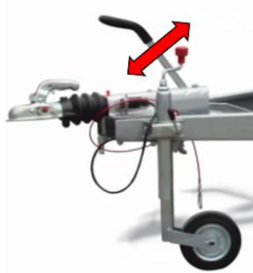
Rys. 6. Ustawienie hamulca postojowego przyczepy
