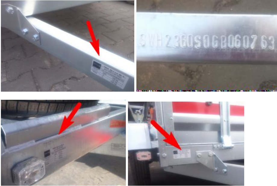
Dis. 1. Posizione della targa dati del rimorchio
