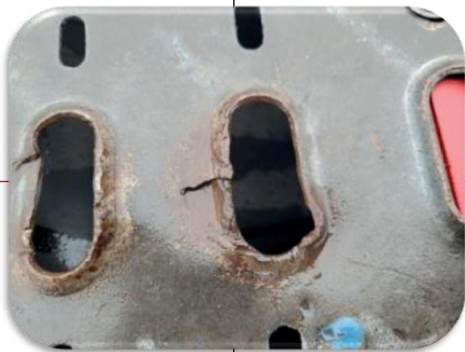
Zu ihrer Überprüfung ist der Zustand aller Öffnungen mit Prägungen optisch zu prüfen, nachstehend wurden Beispielschäden dargestellt, die den Boden disqualifizieren:
